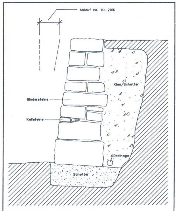
3. Der Unterbau für alle Gala-Bau-Produkte aus Jurakalkstein sollte richtigerweise aus einem mineralischen Bodenaufbau bestehen (kapillarbrechende Schicht).
